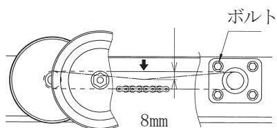
張りの強さはローラチェーンの中央部を指で押してたわみ量が8mmになるのが適正です。
