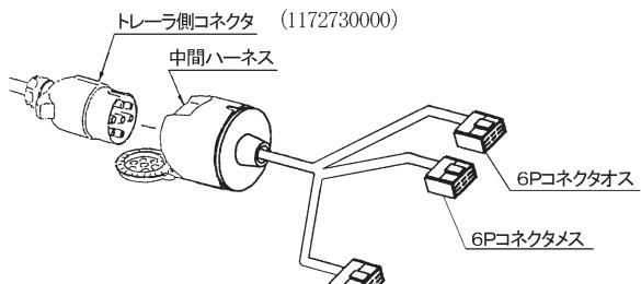
配線替えが必要な場合は、上記「配線一覧表」に基づき、配線の差し替えを行ってください。トラクタによっては一覧表と異なる場合があります。必ず動作確認を行ってください。また、トラクタ側に外部電装品取り出し口が装備されていない場合は、別途トラクタ側コネクタの電気配線が必要となります。
