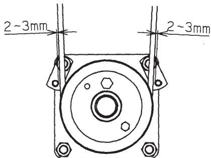
(2) トワイン・ネットを繰出すテンションクラッチのVベルトがすべる場合は、Vベルトの張り量を調整してください。
