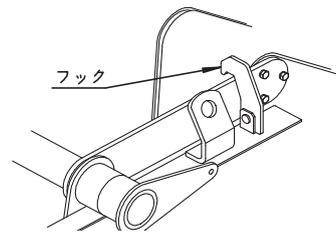
(2) トラクタをアイドル状態外部油圧を操作します。ゲートが1/4程度開いたところでストップバルブを閉じます。
