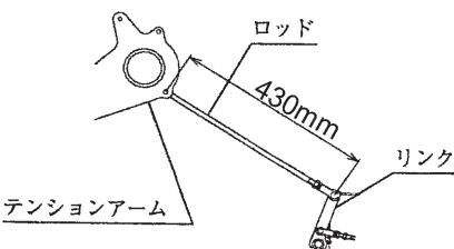
(2) ロッドとリンクボールを止めているロックナットを緩めます。
