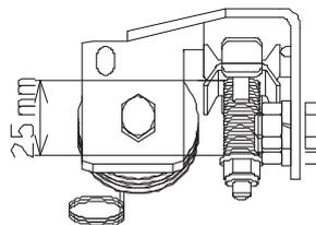
トワインバイディング部のスプリング長さAは37mmに調整してください。
