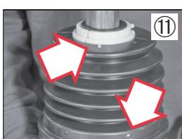
⑪ カバーとベアリングリングの基準ピンが穴に合っていて、基準ピンがきちんと挿入されていることを確認します。カバー固定のプラスネジを締めます。電動ドライバーは使用しないでください。
