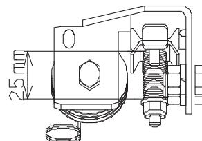
トワインバインディング部のスプリング長さ A は 37 mm に調整してください。
