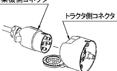
また、トラクタ側に外部電装品取り出し口が装備されていない場合は、別途トラクタ側コネクタの電気配線が必要となります。
