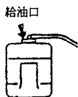
⑭ リザーブオイルタンク
