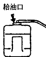
⑭ リザーブオイルタンク
