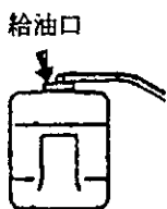
⑭ リザーブオイルタンク
