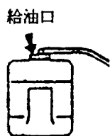
⑭ リザーブオイルタンク
