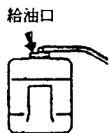
⑭ リザーブオイルタンク
