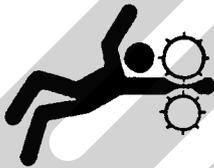
トウィン巻付装置を調整する時、ローラに接触すると巻き込まれ、ケガをする事があります。
