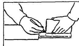
(3) パイプのアウタ・インナ両方を金ノコまたはカッターで切断します。
