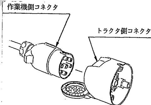
トラクタ側コネクタの電気配線が必要となります。作業機側コネクタの配線は下図の通りです。なおコネクタは接続面方向から見ています。
