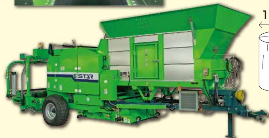
戻しコンベアに加えて回収コンベア装備
