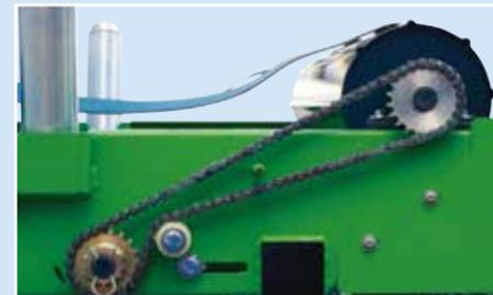
◀ テーブルローラのチェーンテンション調整は、ボルト2本を緩める⇔締めるだけ!
