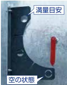
タンクの前後にそれぞれ残量ゲージを配置し、後方からも投入量を確認できます。
