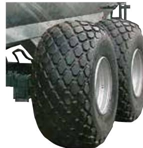
大径タイヤ採用で接地圧を低減し、圃場へのダメージを抑制します。また、不整地・軟弱地においても活躍します。
