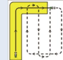
◎肥料がなくなつて作業を中断する場合、中断した位置を記憶、再びそこまでの誘導を行う「ブレークリターンシステム」を設けています。
