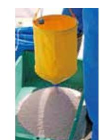
肥料20kgを2回に分けて肥料流動測定器を投入し、肥料流動測定値を算出します。自動補正が始まるまでの散布誤差を最小限に抑え散布開始時からより正確な肥料散布が行えます。
