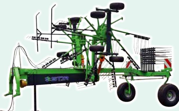
ティンアームを収納することで全高が低くなります。リンチピンでの固定なので取り外しも簡単です。
