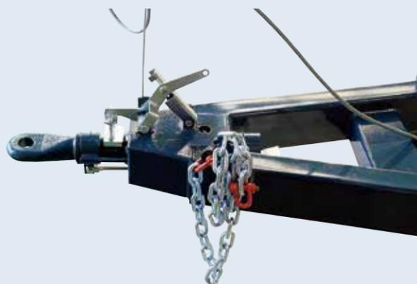
ヒッチ部の動きによって作動する慣性ブレーキ方式を採用。トラクタのブレーキを踏むとトレーラの慣性によってブレーキがかかり、停止時のショックを和らげます。
