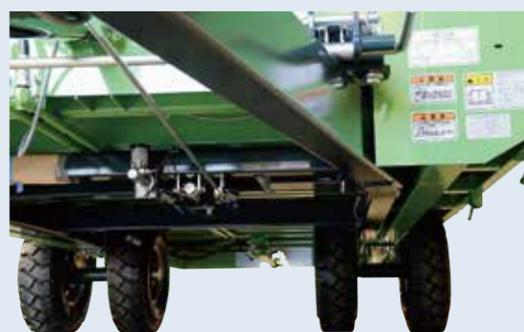
5000シリーズは4輪中の2輪に、8000シリーズは8輪中の4輪に連動ブレーキを装備。トラクタのブレーキ信号と連動して農業用トレーラのブレーキがかかるのでより安全な走行が可能です。(灯火装置用電源との接続が必要です)
