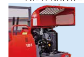
エンジンカバーの開閉ワンタッチ化 ※JMS13・18シリーズのみ
