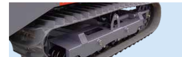
グリスアップ不要のトラックローラ・アイドラローラ・アッパローラ
