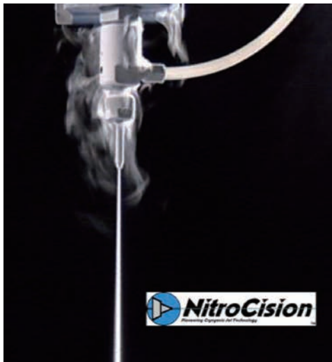
超高压の液体窒素を吹き付け、洗浄、はつり、切断ができます
