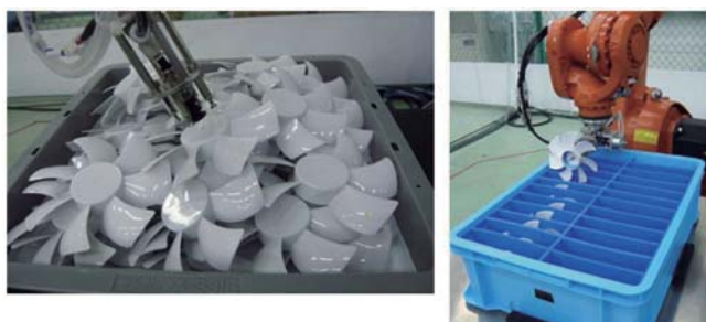
第 6 図 ワークの取り出しと配置の状況の例 Fig. 6 Robotic handling behavior
