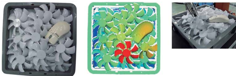
第 7 図 異物混入時のワークの三次元位置・姿勢の認識結果例 Fig. 7 Results of 3-D recognition of fans by discerning from foreign objects
