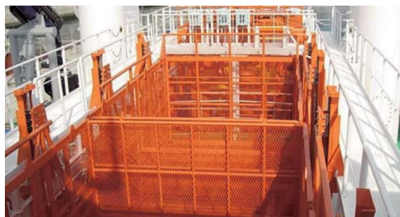
第4図 コンテナ昇降式ゴミ回収装置
