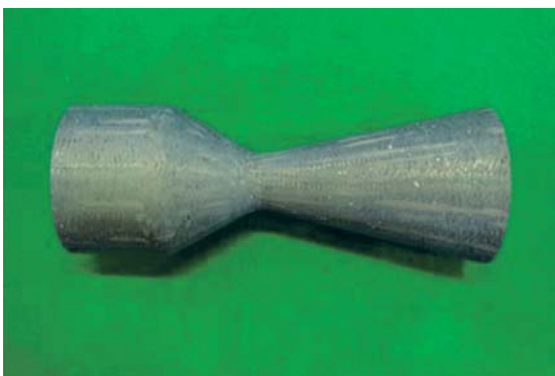
第 9 図 加工後の CMC ノズルの外観 Fig. 9 Appearance of CMC nozzle after machining
