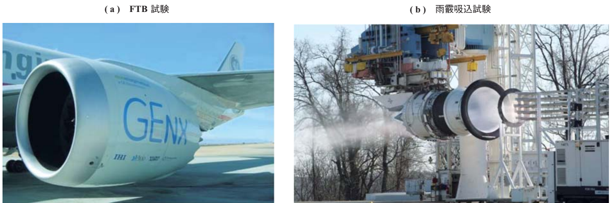
第 4 図 GEnx エンジンの各種試験状況 Fig. 4 GEnx engine tests
