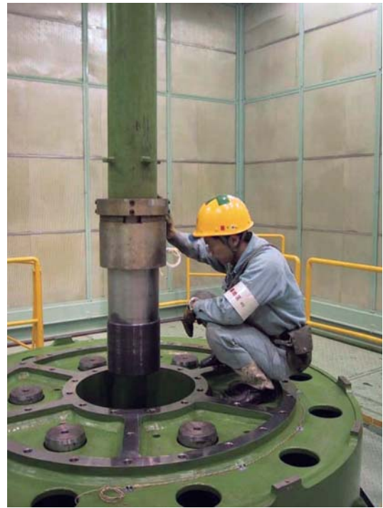
第4図 破断ボルト組付けの様子 Fig. 4 Assembling status of sheared bolt
