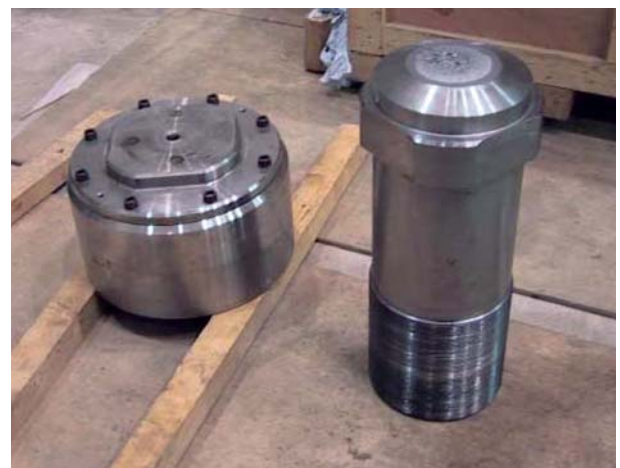
第5図 衝撃試験後の破断ボルト Fig. 5 Sheared bolt after testing
