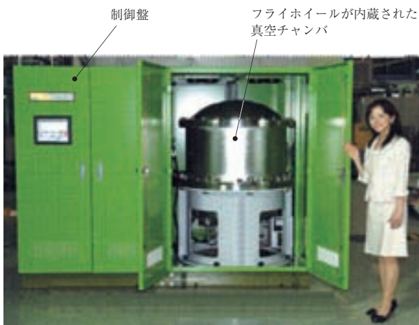
第2図 機械式2次電池の装置外観 Fig. 2 Overview of mechanical secondary battery
