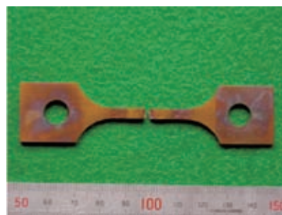
(d) Alloy52 の延性破面 (SCC 感受性なし)
