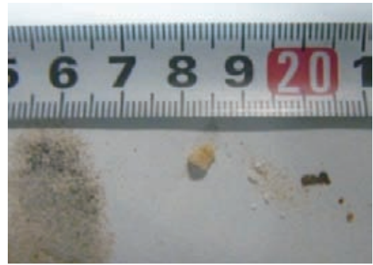
第 5 図 凝集した主灰の様子 Fig. 5 Agglomerated bottom ash in the combustor
