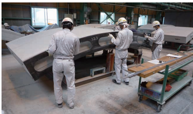
ゲージ板着脱状況
