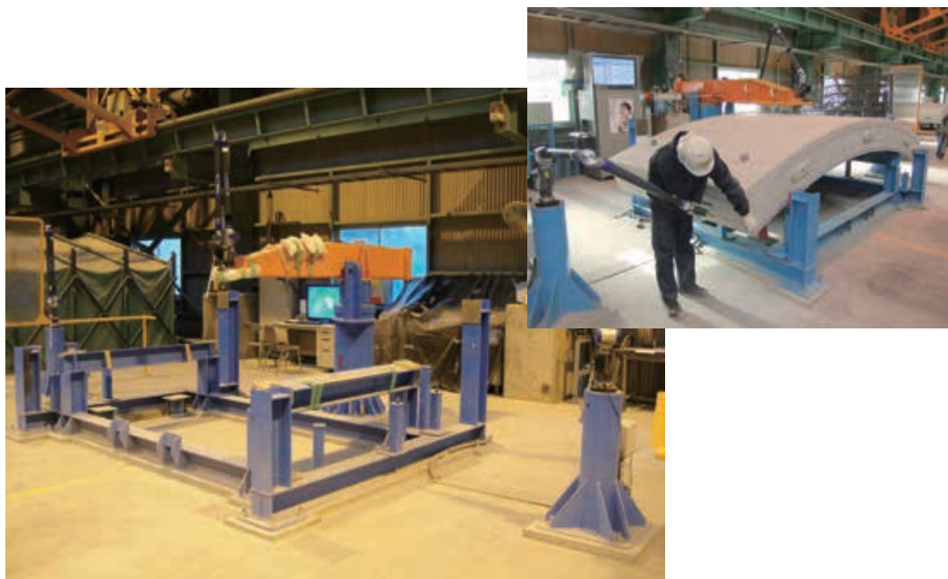
三次元寸法計測システム（左下：全景，右上：計測状況）
