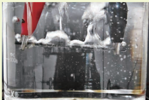
加熱を続けると鉛筆の表面が蒸気の膜で覆われるようになります。このまま加熱を続けると鉛筆の芯は焼き切れてしまいます。
