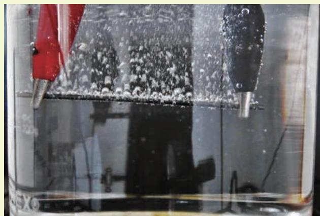
水が入ったビーカーの中に鉛筆の芯を入れ電流を流し加熱しています。鉛筆の芯の表面から小さな泡が出ています。
