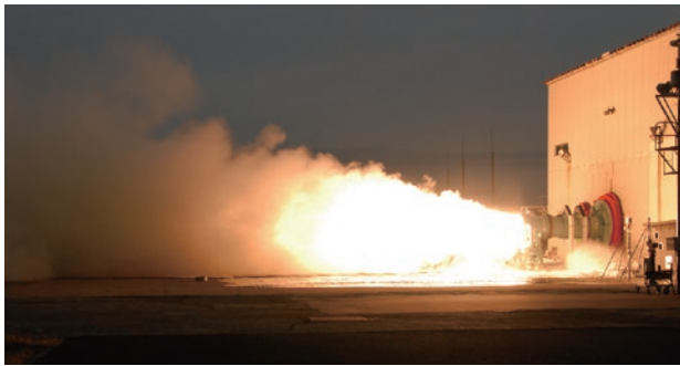
2 段モーター燃焼試験 ©JAXA
