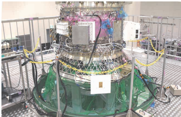
3 段機器搭載構造に機装された PSDB
