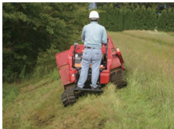
傾斜地でも水平姿勢を保つスイング機構
