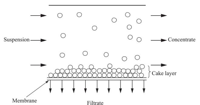
**Fig. 8** Tangential flow filtration <sup>(2)</sup>
