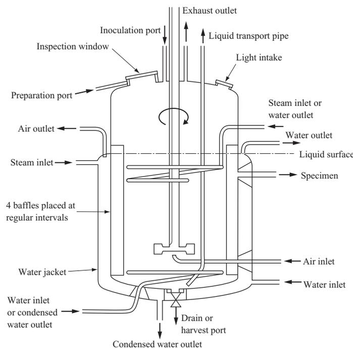
Fig. 2 Bioreactor<sup>(1)</sup>
