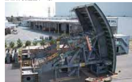
尾原ダム(島根県) 設備名:非常用放流設備(クレストゲート) 形式:鋼製ラジアルゲート 数量:2門 純径間:11.500m 有効高:14.020m 開閉装置形式:油圧シリンダー式 竣工年:2011年
