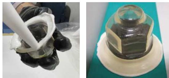
本製品は、つば部のみの接着で十分な接着性、密閉性を確保できることを実験により確認しました。「透明ボルトアイキャップ つばのみ接着法」は琉球大学との共同研究成果です。
