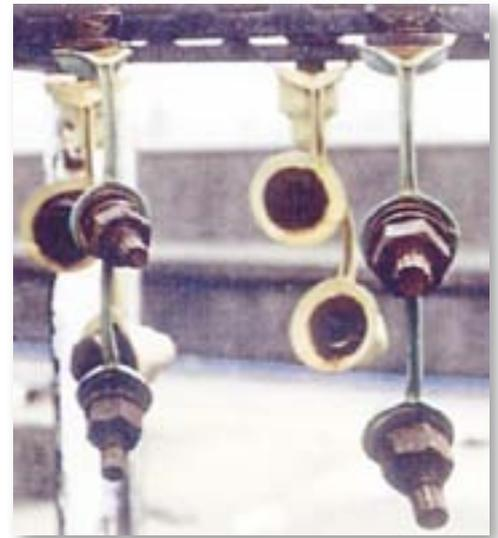
トルクシヤーボルトの丸い頭にキャップを接着し、M22 のボルト 2 本を吊り下げています。ボルト 2 本の重さにより、長さは 2 倍近く伸びています。伸びきった状態で紫外線にさらされることは、高分子化合物では過酷な条件です。試験場の都合で撤去するまで、約 12 年風雨にさらさせましたが、切れることはありませんでした。
