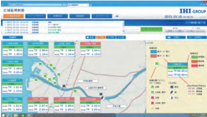
山国川樋門樋管遠隔監視制御設備 (流域監視画面)
