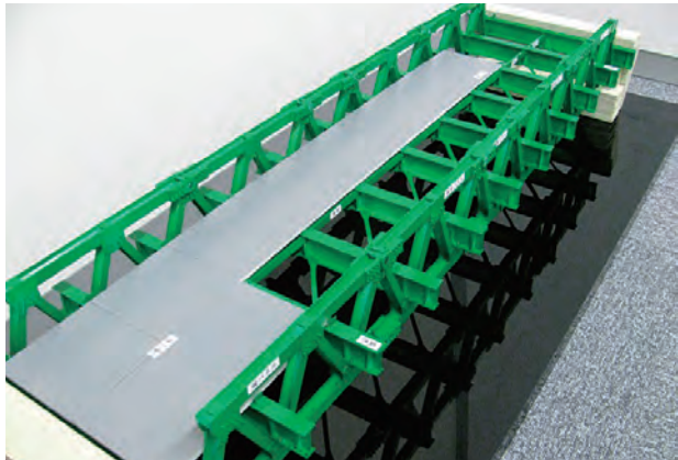
トライアスの構造モデル(下路タイプ)
