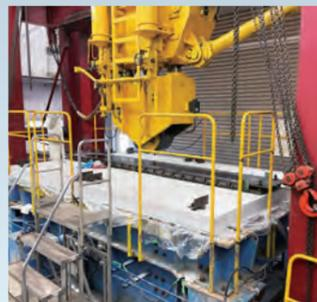
我が国の道路橋床版は、交通量の増加や車両の大型化の影響により、補修・補強を必要とする損傷が顕著になっています。本試験機は車輪による荷重を負荷させた状態で載荷装置を移動させることで実際の輪荷重に近い条件を再現し、道路橋床版の破壊メカニズムの解明および、新しいタイプの床版、補強・補修工法の疲労耐久性を検証する試験を行っています。IISが保有する試験機は国内でも数台しかない大型の試験機で、様々な試験条件に対応できます。
