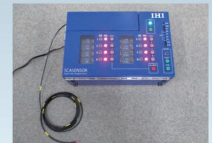
スカセンサー(Smart Color Analyze Sensor)は光ファイバーとデジタルRGB判定器を用いたコンクリート充填判定装置です。センサー先端部が小型化されており、判定後撤去が可能で、コンクリート構造物に異物を残しません。
