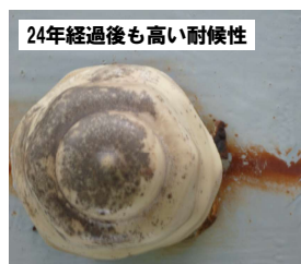
24年経過後も高い耐候性 沖縄沿岸地区 曝露試験 24年間（1989～2013年：現在も試験継続中）
