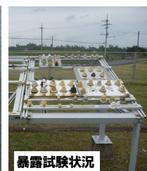
内部ボルトに腐食無し 日本ウェザリングテストセンター宮古島 曝露試験10年以上経過（2001～2011年：現在も試験継続中）
