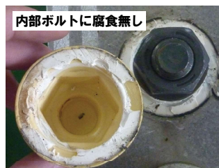
内部ボルトに腐食無し 日本ウェザリングテストセンター宮古島 曝露試験10年以上経過（2001～2011年：現在も試験継続中）
