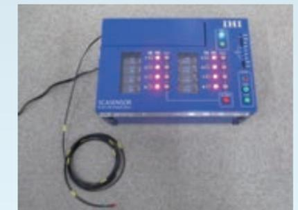
スカセンサー(Smart Color Analyze Sensor)は光ファイバーとデジタルRGB判定器を用いたコンクリート充填判定装置です。センサー先端部が小型化されており、判定後撤去が可能で、コンクリート構造物に異物を残しません。
