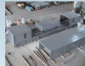
海上クレーンの吊り枠に装備する制振装置です。強風や波浪による吊り枠の揺れを低減し、吊り荷の玉掛け作業の安全性の向上に役立ちます。
