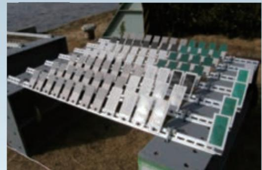
鋼橋や水門ゲートの耐久性を向上させ、LCC(ライフサイクルコスト)の低減を図るには、これらの腐食による損傷劣化を防止することが有用です。弊社では、各種防食法に対する腐蝕試験を実施し、防食技術向上に向けた研究開発を行っています。
