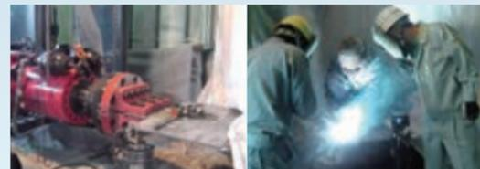
今後ますますニーズが高まると予想される社会インフラの補修・補強技術の一環として、道路供用下での鋼床版補修工事を想定して鋼床版に生じる振動をアクチュエータで再現し、溶接欠陥を生じにくい溶接材料と溶接条件の検討を進めています。
