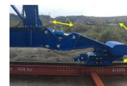
走行部ジャッキ伸縮動作
