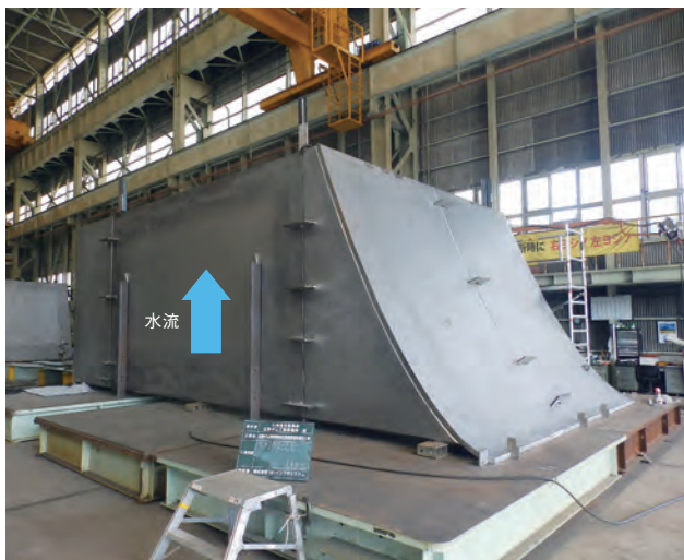
写真-2 下段放流管 上流側ブロック
