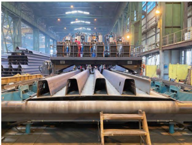
写真-5 逆歪による溶接変形対策
