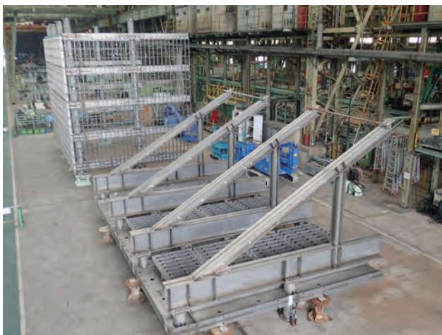
写真-6 上段スクリーン 仮組立状況 (奥:6BL①～⑤桁、手前:8BL受台～①桁)
