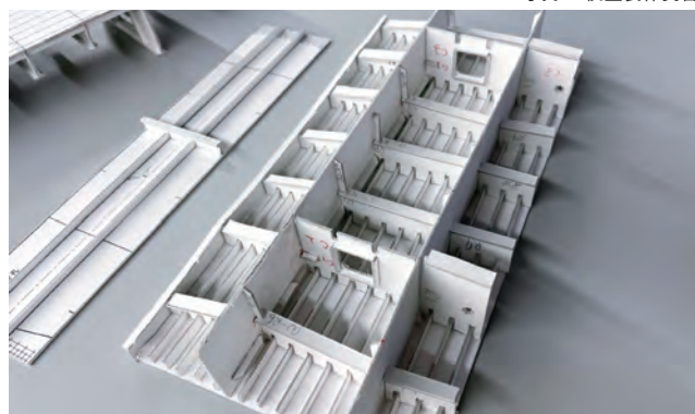
写真-3 製作中の模型（鋼床版箱桁）
