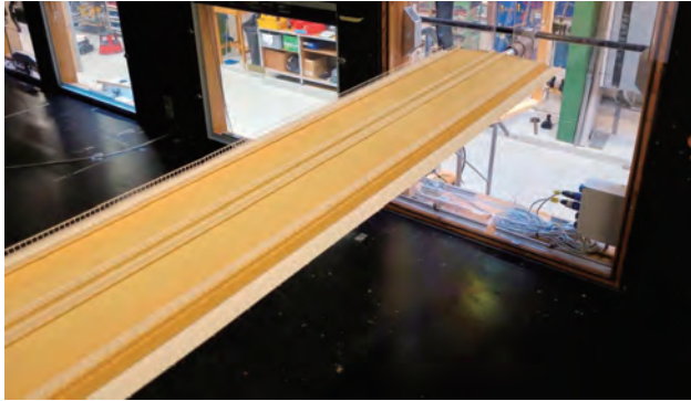
写真-1 補剛桁2次元模型(1/75)
