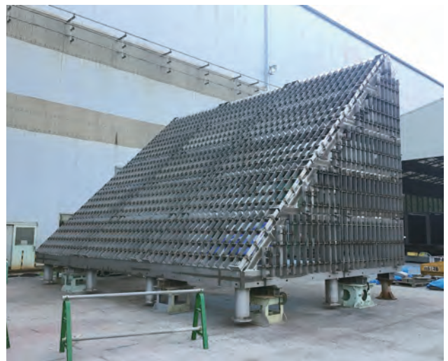
写真-8 上段スクリーン 仮組立状況(6BL⑨～⑭桁)
