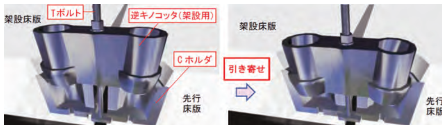
図-5 架設用部材「逆キノコッタ」による架設床版の引き寄せ
