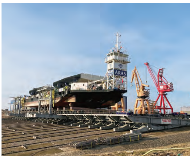
写真-20 昇降装置によるバージ進水
