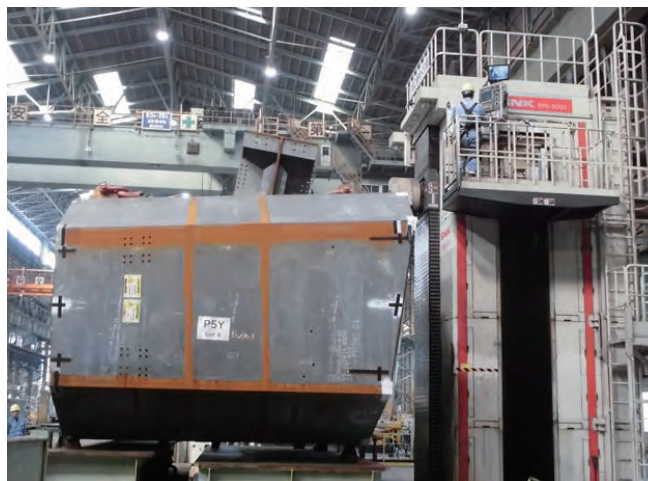
写真-2 端面切削状況
