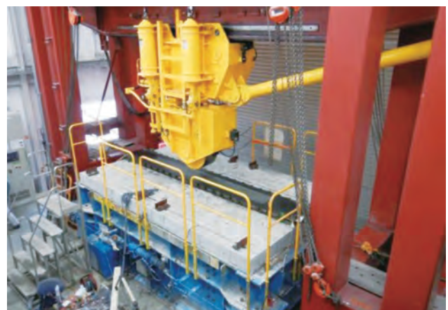
写真-6 輪荷重走行試験機
