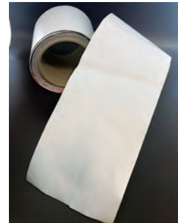
写真-3 貼付型防食部材 実物写真
