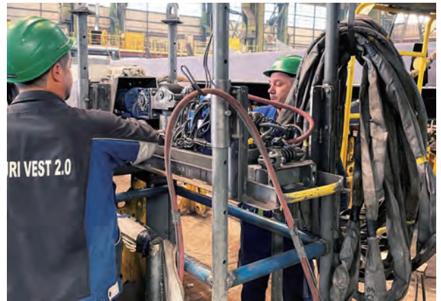
写真-6 トラフ内面検査装置
