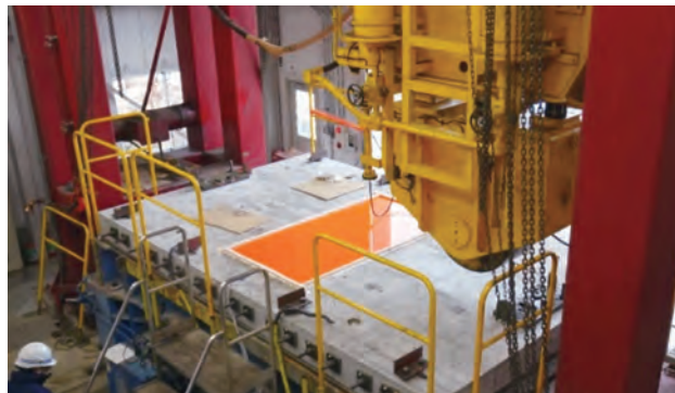
写真-4 水張り試験
