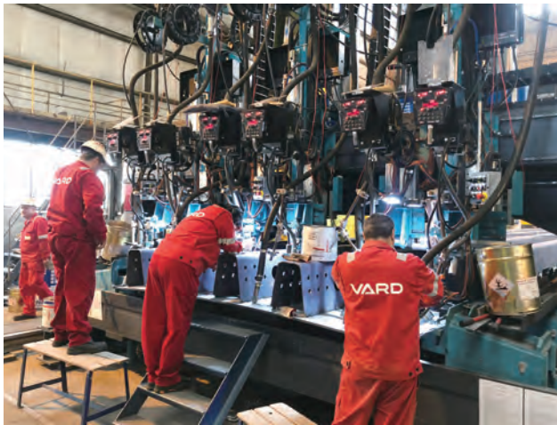
写真-4 6電極サブマージアーク溶接機
