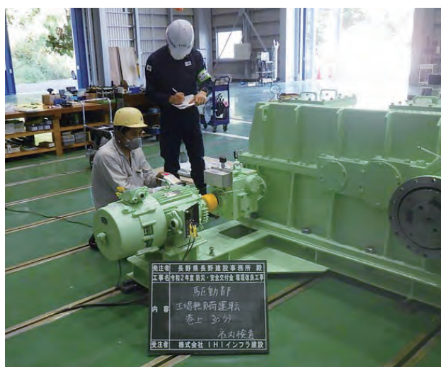
写真-2 工場無負荷運転検査
