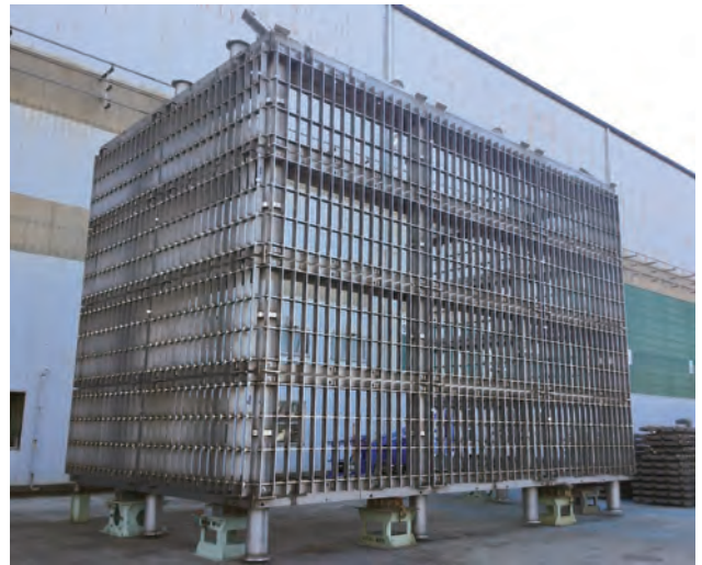
写真-7 上段スクリーン 仮組立状況(8BL⑤～⑨桁)
