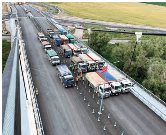
写真-31 静的荷重載荷試験の状況
