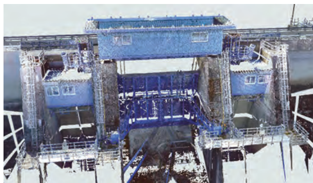
図-1 3次元計測による点群データ
