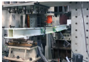
耐荷力試験(縦桁3点曲げ)
