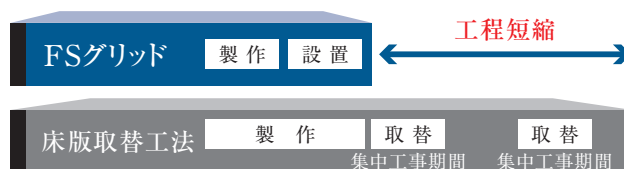
図-2 FSグリッドによる工期短縮イメージ
