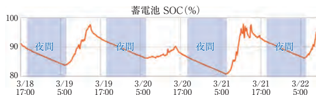
図-10 蓄電池SOCの変動
