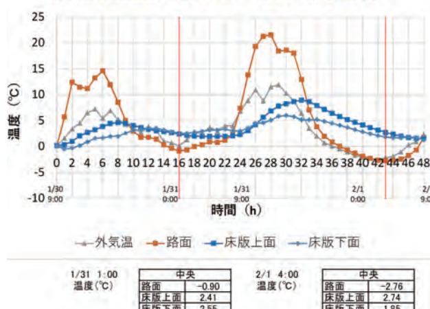
図-13 ②床版支間中央部
