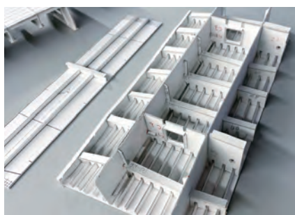
写真-2 製作中の模型（鋼床版箱桁）
