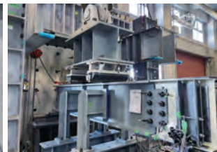
接合部疲労試験
