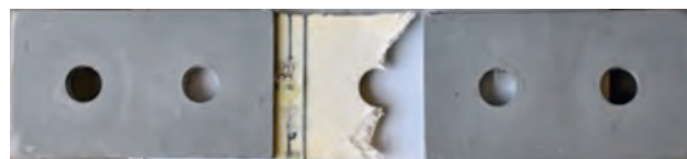
(c) 純断面引張破壊(摩擦接合: R2-FA-3)
