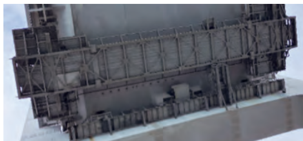
写真-2 点検作業車(地上から撮影)
