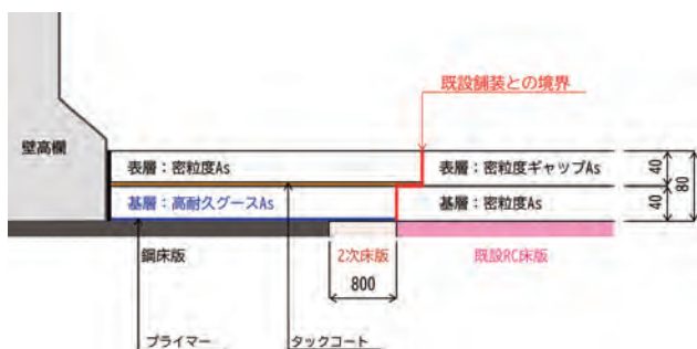
図-16 拡幅部の舗装構成
