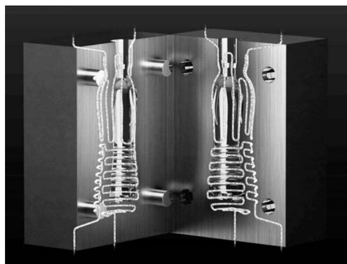
写真1 拡散接合で3次元流路を持つ金型も製造できる。
