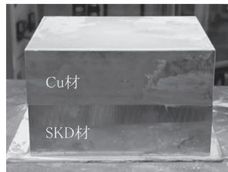
写真 2 SKD 材と Cu 材の接合ブロック
