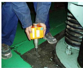
シュミットハンマーにて基礎表面 硬度を測定し、コンクリート圧縮強 度を推定
