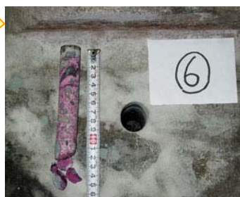
コンクリートのアルカリ反応を調査す るためサンプリングした供試体の表 面にフェノールフタレイン水溶液を塗 布し中性化の進行を確認
