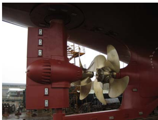
写真1. 日本丸に搭載された二重反転プロペラ
