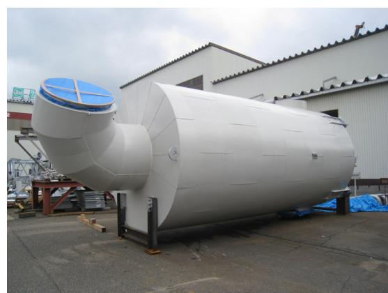
工場では、大型消音器を横に寝せた状態で作業できるため、作業の足場もなく、高所作業も大幅に削減されます。これにより、現地作業は、約3週間も削減されました。
